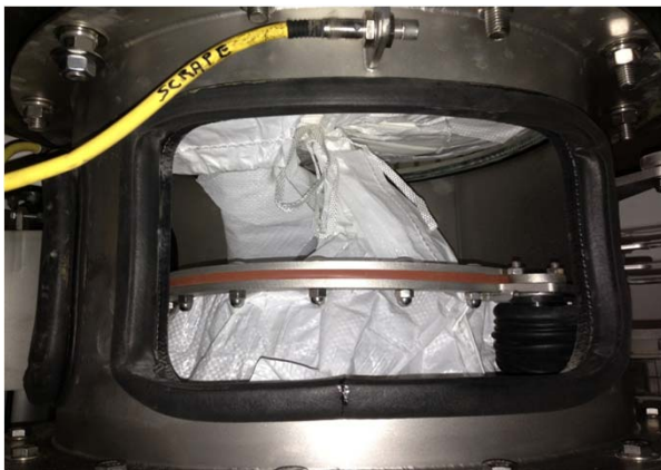
3. Refermer le dispositif d'étanchéité sur le tube de décharge
