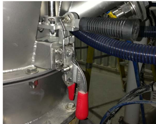
4. Barrer le dispositif d'étanchéité
