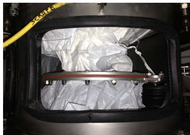
5. Défaire le noeud de la goulotte du super-sac et laisser couler librement
