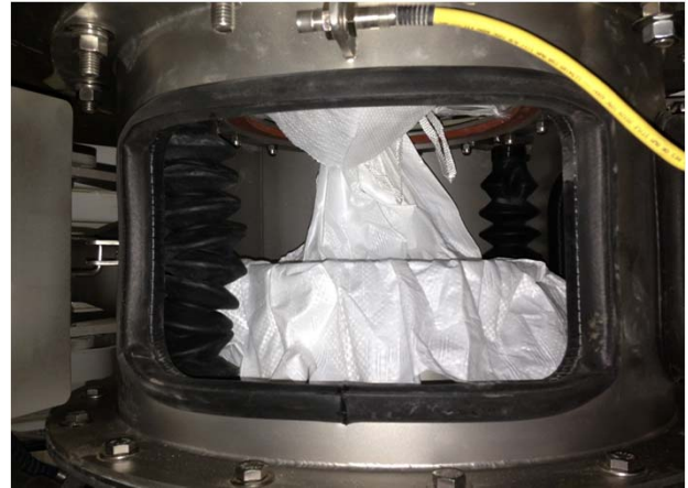
2. Envelopper la goulotte sur le tube de décharge
